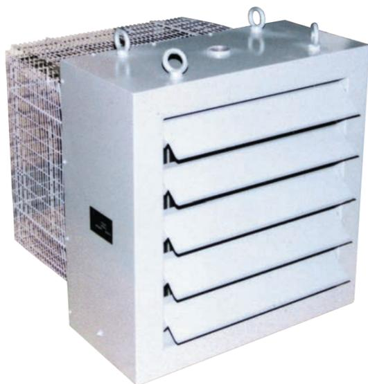
ユニットヒーターは工場、倉庫、市場など、床面積が大きく、天井の高い建物の温風暖房装置として快適な暖房を実現します。また、施設の状態に応じて空気を適度に循環させるための、上下吐出方向の調節も容易にできるようになっています。ケーシングに吊り環を付けていますので、天井または壁に掛けることができ、省スペースを実現します。
