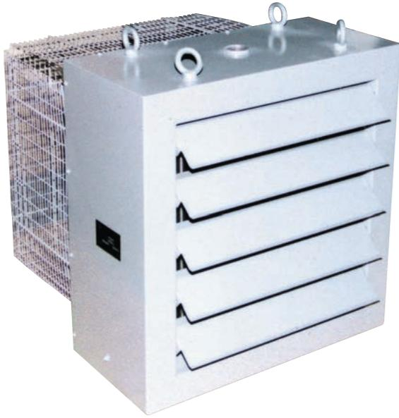
ユニットヒーターは工場、倉庫、市場など、床面積が大きく、天井の高い建物の温風暖房装置として快適な暖房を実現します。また、施設の状態に応じて空気を適当に循環させるための、上下吐出方向の調節も容易にできるようになっています。ケーシングに吊り環を付けていますので、天井または壁に掛けることができ、省スペースを実現します。
